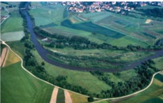
2001 wurde am Abschnitt »Unterwasser« eine Flutmulde angelegt (rechts). Das linke Bild zeigt eine Rekonstruktion des vorigen Zustands.
